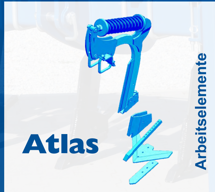
Eine ATLAS-Zinke eingestellt für den Einsatz als Tiefenlockerer
